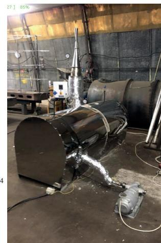
Рисунок 3 – Схема и общий вид установки для получения жидких продуктов пиролиза древесины
