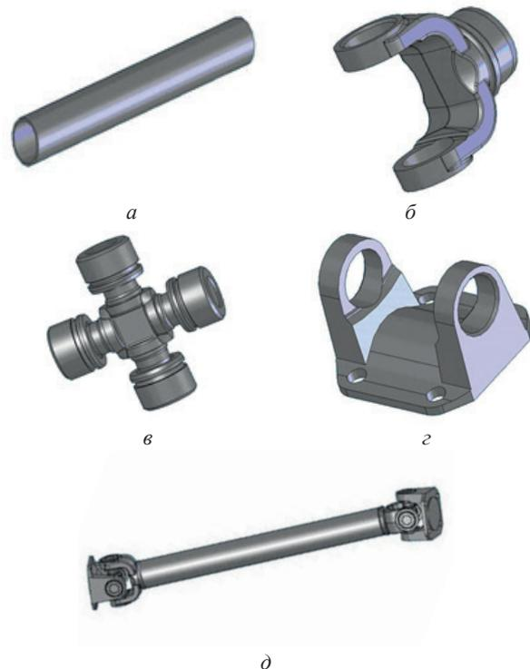
Рисунок 14 – Элементы трехмерной модели двухшарнирной КП:
