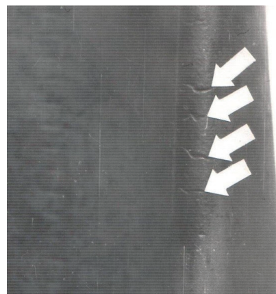
Рисунок 1 — Термоусталостные трещины на входной кромке соплового аппарата ТВД ТРДДф
