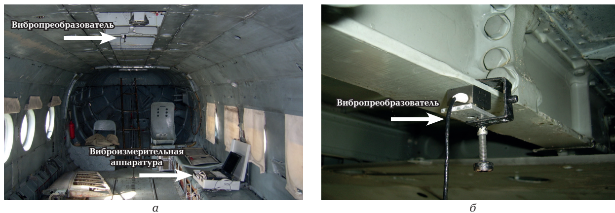
Рисунок 2 – Размещение вибропреобразователя при контроле ТС главного редуктора вертолета типа Ми-8
