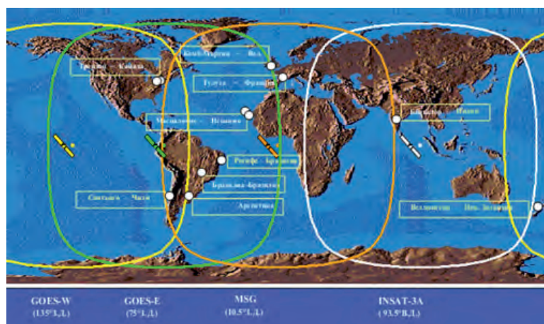
Рисунок 4 — Зоны покрытия системы КОСПАС-SARSAT 406 МГц и ГЕОСПОИ
