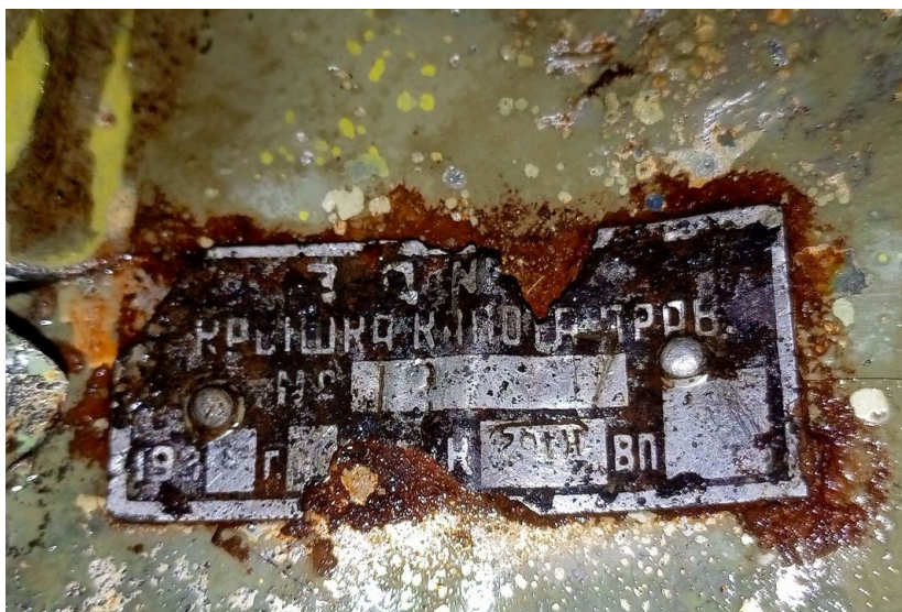
Рисунок 2 – Шильда с сокращенным номером планера
