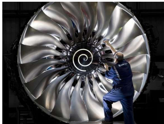
Рисунок 1 – Лопатки компрессора, выполненные из титана
