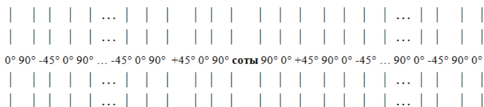
Рисунок 1 – Схема укладки слоев ПКМ с учетом сотового заполнителя
