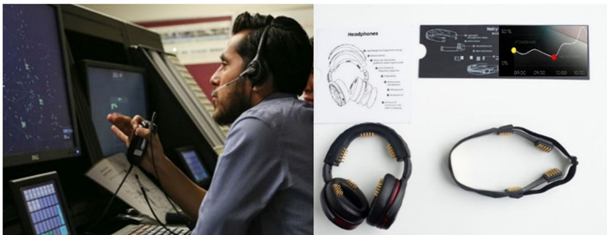
Рисунок 2 – Совмещение нейроинтерфейса с оборудованием рабочего места диспетчера УВД (пример нейроинтерфейсных устройств компании ООО «Нейри»: Neiry Headband (Mind Tracker), Neiry Headphones)
