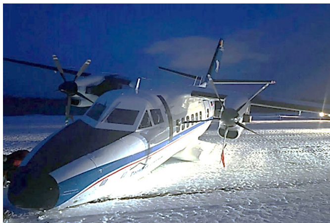
Рисунок 3 – Шасси сломалось у самолета L-410 при взлете во время тренировки в Якутске 17 апреля 2023
