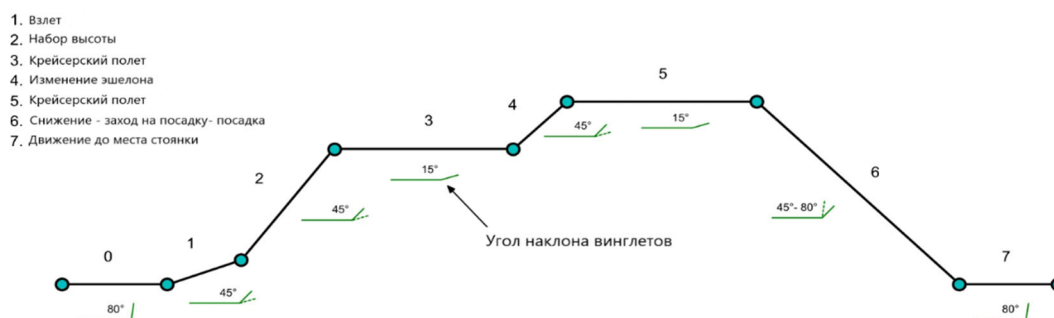
Рисунок 4 – Рекомендации по настройке винглета на различных этапах полета
