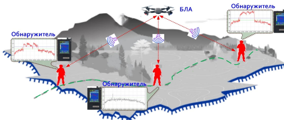
Рисунок 1 – Пример влияния условий наблюдения на спектр принятого сигнала от ИРИ
