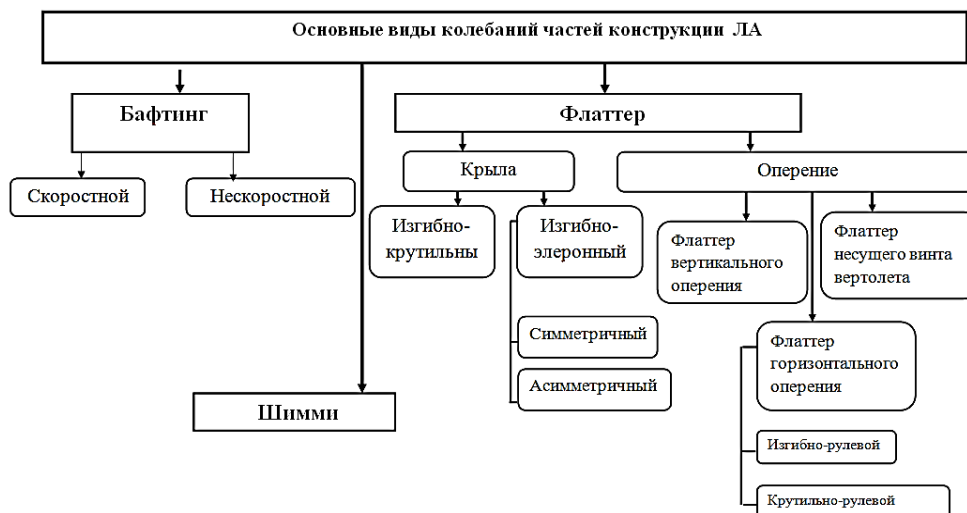
Рисунок 1 – Основные виды колебаний в конструкции ЛА
