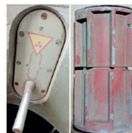
Рисунок 1 — Радиоизотопный индикатор обледенения РИО-3 и свинцовый чехол для его чувствительного элемента
