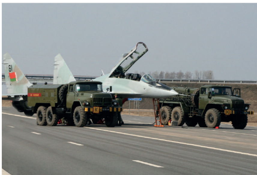
Рисунок 1 – СНОП УГЗС МА-131 (ЗиЛ-131) – слева, АПА-5Д (УРАЛ-4320) во время технического обслуживания самолета
