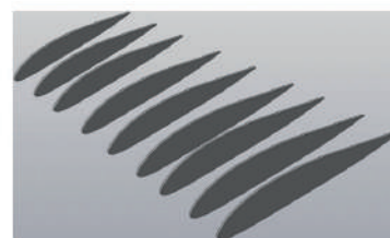
Рисунок 3 — 3D-модели нервюр фрагмента отъемной части крыла самолета Як-18 в месте расположения элерона («заготовки» 3D для моделей нервюр элерона)
