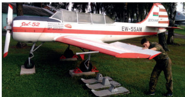
Рисунок 4 — Курсант и член КНО БГАА производит монтаж элерона на левое полукрыло самолета Як-52 — экспоната МАТ МАК ДОСААФ
