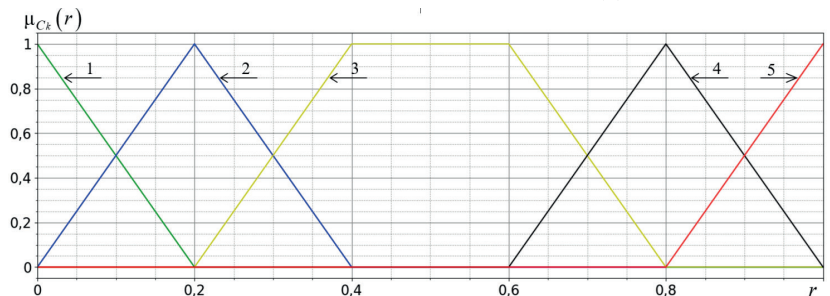
Рисунок 4 – Функции принадлежности терм-множества ЛП «Риск»: 1 – низкий \mu_C(r) ; 2 – ниже среднего \mu_C(r) ; 3 – средний \mu_C(r) ; 4 – высокий \mu_C(r) ; 5 – очень высокий \mu_C(r)
