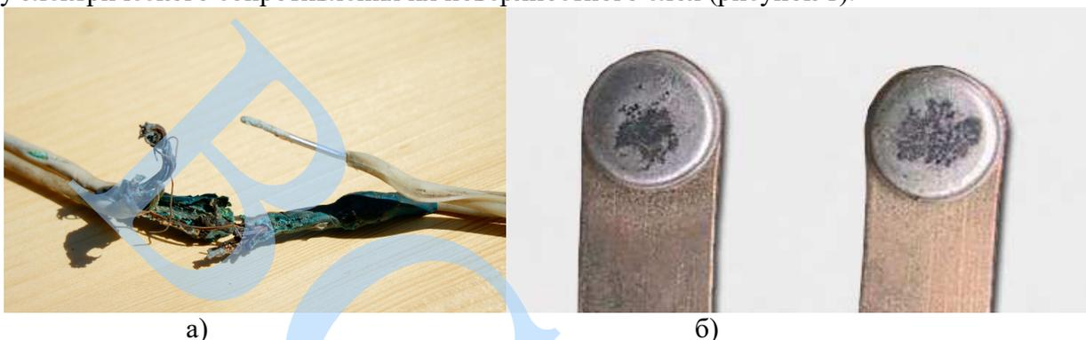
Рисунок 1 – Коррозия электропроводки (а), искровая электроэрозия (б)
