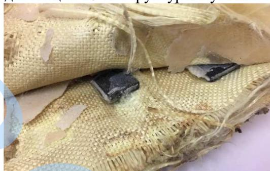
Рисунок 2 – Результат испытаний противопулевой защиты структуры с углепластиком ВКУ-25.
