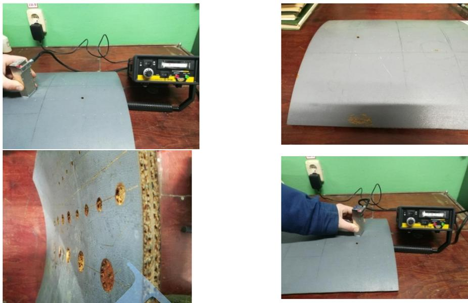
Рисунок 3 – Проведение акустического импедансного метода контроля
