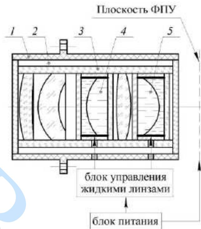
Рисунок 1 – Конструкция вариообъектива-моноблока на жидких линзах:
