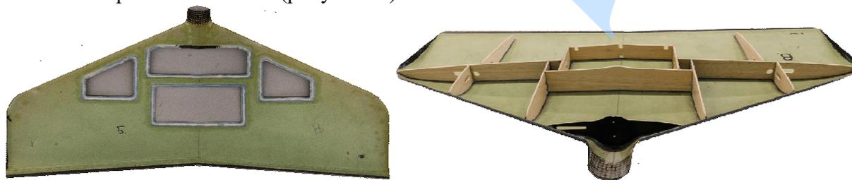
Рисунок 1 – Конструкция планера БЛА «Москит»
