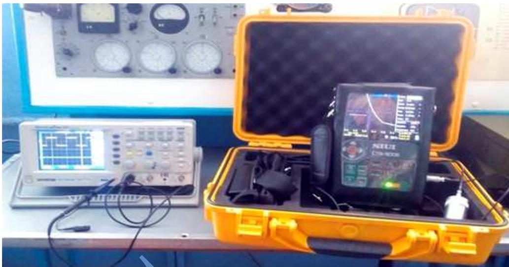
Рисунок 2 – Внешний вид дефектоскопа SIUI CTS-9006
