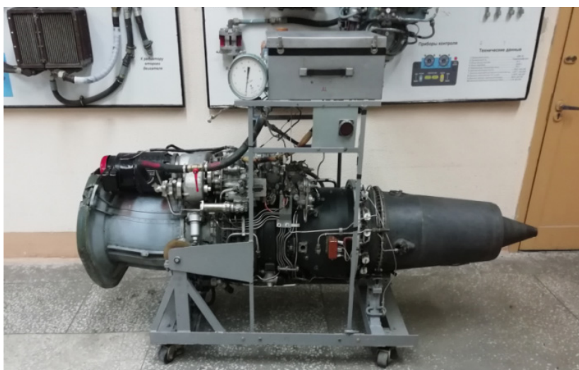
Рис. 6. Внешний вид газочного стенда ТР3–117
