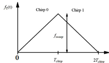
Fig. 25. FMCW radar waveform.
