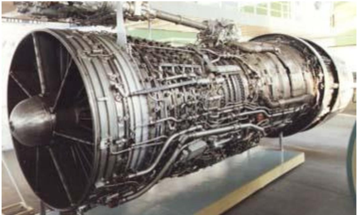
Рисунок 4 - Двигатель РД-36-51
