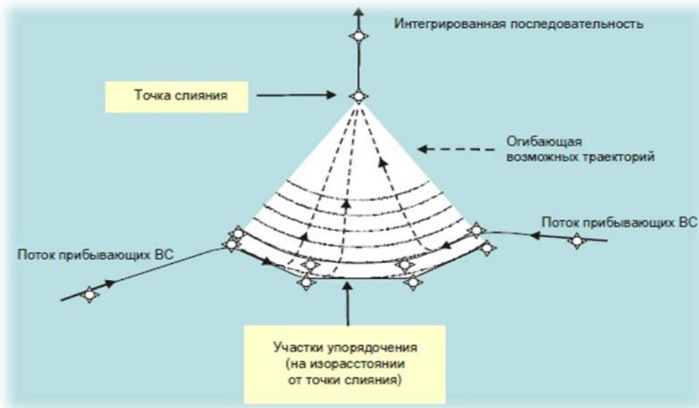
Рисунок 5 – Типовая схема «Point merge system»
