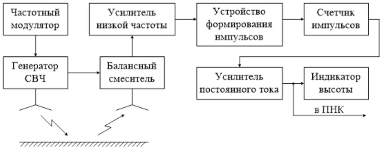
Рисунок 3 – Структурная схема радиовысотомера
