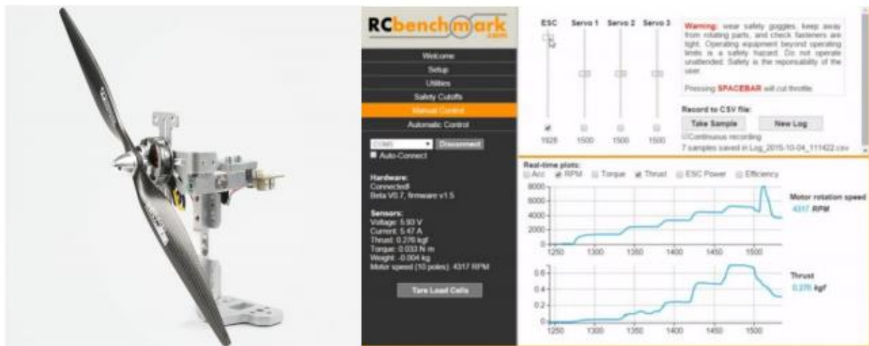
Рисунок – 2. Стенд от компании Tyto Robotics и вид экрана при испытаниях ВМГ
