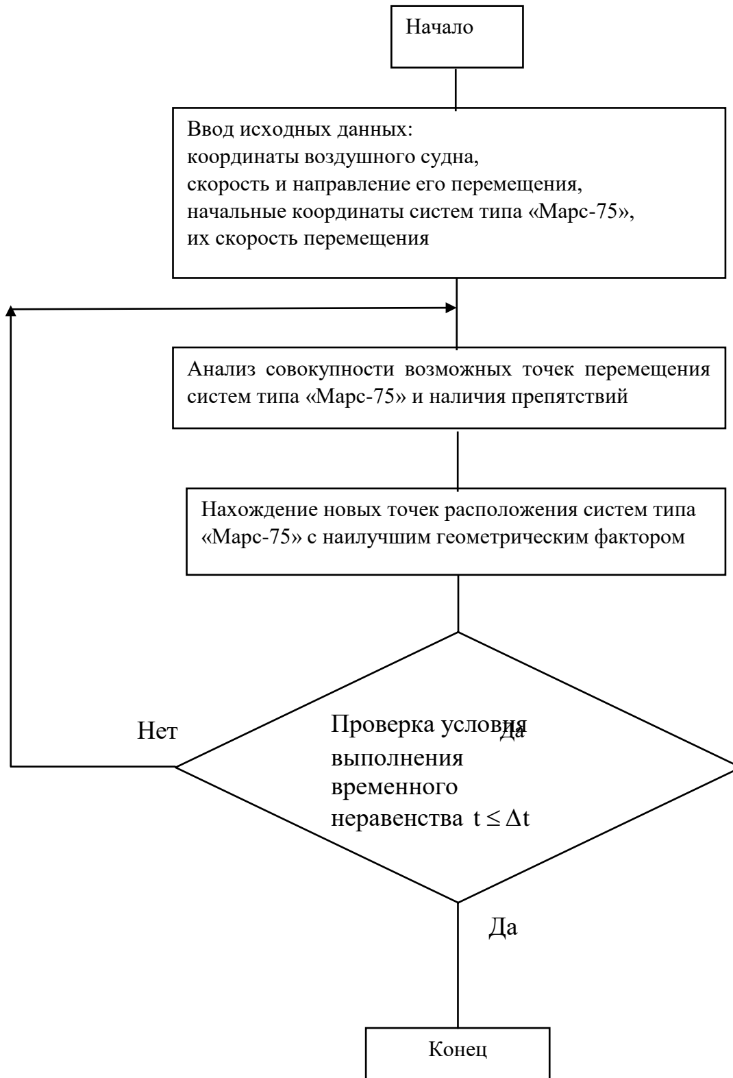
Рисунок 2. Блок-схема алгоритма выбора новых точек размещения систем наземного дополнения типа «Марс-75»
