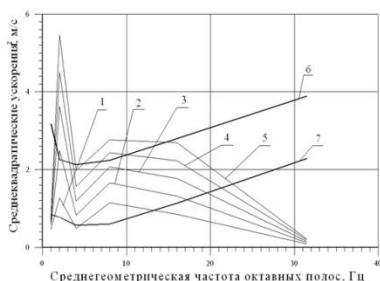
Рисунок 2 – Зависимость среднеквадратических ускорений точки поддрессоренной массы автомобиля над передним мостом в зависимости от возмущения при различной жесткости и постоянной демпфирования передней подвески; 1 – c_p = 600000 Н/м; 2 – c_p =
