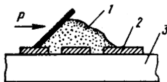
Рис. 170 Нанесение пасты на подложку: 1 - паста; 2 - трафарет; 3 - подложка
