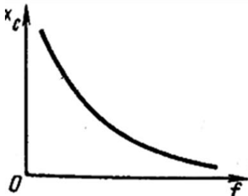
Рис. 30 Зависимость ёмкостного сопротивления X_C от частоты f
