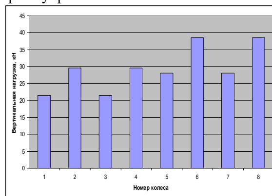
Рисунок 14 – Распределение максимальной вертикальной нагрузки по колесам четырехосной машины
