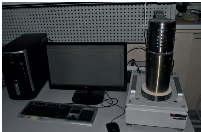
Рис. 1. Общий вид установки для дифференциально-термического анализа (ДТА) и термогравиметрического анализа (TGA) «Thermoscan-2» (USB, TGA модификация)
