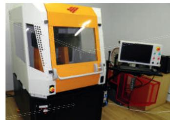
**4. Трёхкоординатный фрезерный станок с ЧПУ Clever CNC Rh300.** Предназначен для обработки легкообрабатываемых материалов с высокой точностью и производительностью. Пригоден для обработки стали и труднообрабатываемых материалов на щадящих режимах.
