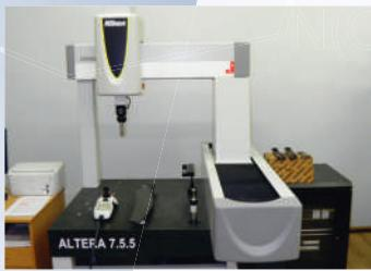
**5. 3d-сканер Nikon Altera 7.5.5 с LC15 Dx.** Координатно-измерительная машина премиум-класса серии ALTERA, с лазерным сканированием сложных криволинейных поверхностей. Точность сканирования достигается до 1,8 мкм за счёт керамической конструкции с почти идеальной удельной жёсткостью и большой устойчивостью к изменениям температуры, гарантирующая исключительные и стабильные результаты в любых производственных условиях.
