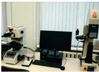
**9. Твердомер аналоговый AFFRI-URBV-V.** Предназначен для измерения твердости металлов и сплавов, пластиков, мягкой и твердой резины по стандартизованным шкалам твердости Роквелла (HRA, HRB, HRC, HRN, HRT) по ГОСТ 9013-59, Виккерса (HV) по ГОСТ 2999-75, Бринелля (HB) по ГОСТ 9012-59.
