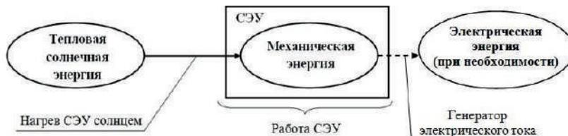
Рис. 1. Принцип работы СЭУ
