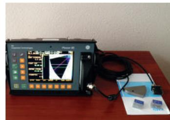
материале, сосудов давления, котлов, транспортных и мостовых конструкций и других объектов. Переносной и прочный прибор объединяет преимущества фазированной решетки с обычным ультразвуковым дефектоскопом, отвечающим принятым нормам.
