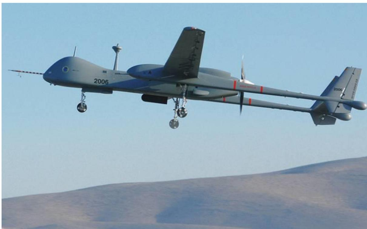
*Рис. 8 Eitan - самый тяжелый разведывательно-ударный БПЛА Израиля.
