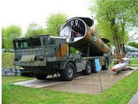
*Рис.1 Советский БПЛА Ту-143 в составе пускового комплекса ВР-3*
