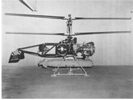
*Рис.2 Радиоуправляемый боевой вертолёт QH-50 DASH (1961).*
