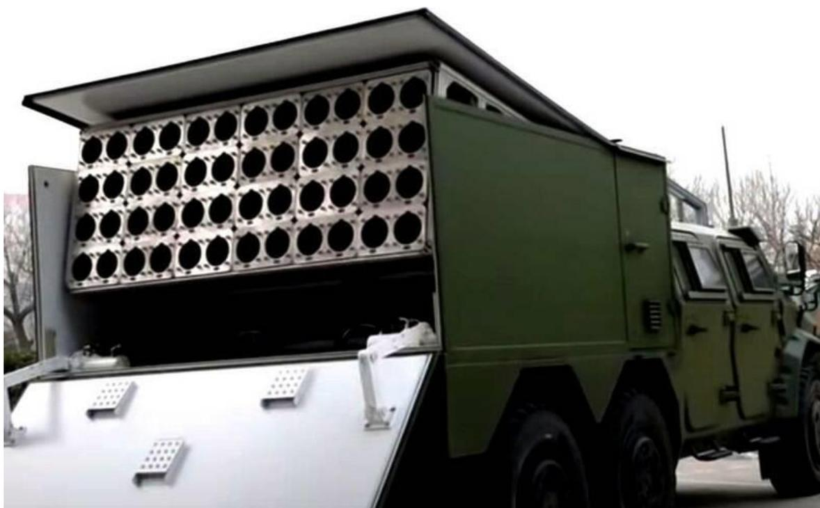
Рис.14 Установка оснащена 48 дронами
