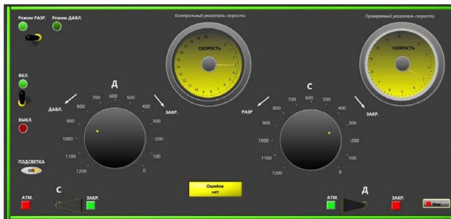
**Рисунок 1 – Внешний вид виртуальной лабораторной установки контрольно-поверочной аппаратуры приемника воздушного давления (КПА-ПВД)**
