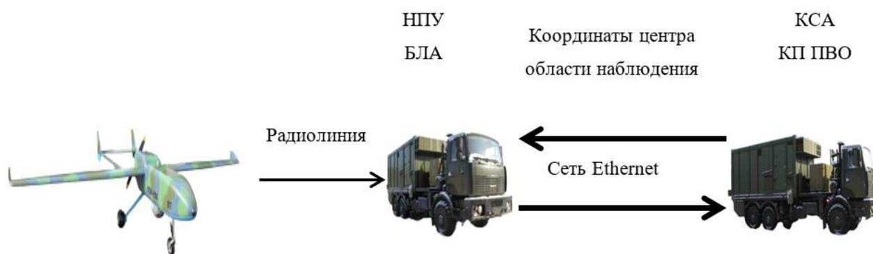
Рисунок – Схема подключения видеoinформации от НПУ БЛА
