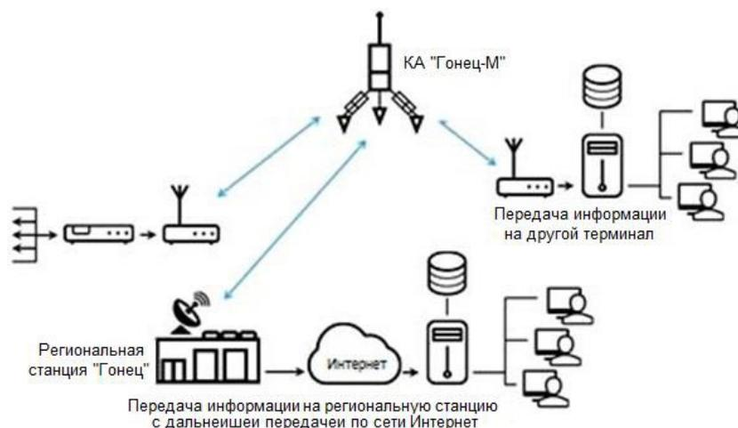
Рисунок 1 – Типовая система связи с использованием системы «Гонец»
