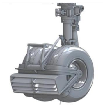
**Рисунок 1 – Трехмерная модель не тормозных колес в составе опоры шасси**
