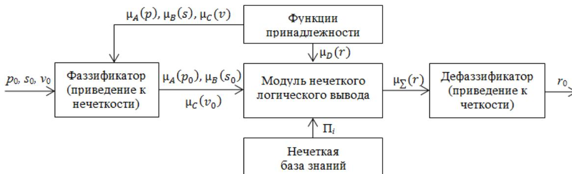
Рисунок 1 – Схема процесса нечеткого логического вывода оценки риска
