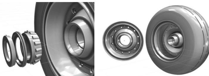
**Рисунок 8 – Стопорное кольцо, сальник, подшипник и колесо после демонтажа половины барабана**
