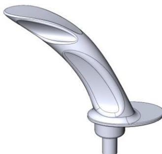
**Рисунок 3 – Модель заготовки рукоятки**
