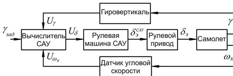
Рисунок 1 – Структурная схема САУ креном
