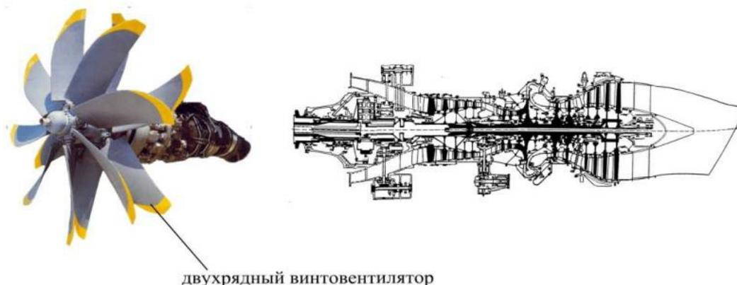
Рисунок 3 – Общий вид и конструктивная схема ТВВД Д-27
