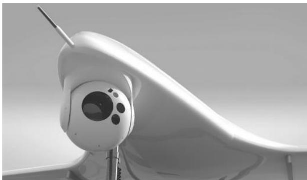
Рисунок – Твердотельная модель оптоэлектронной системы
