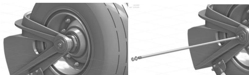
**Рисунок 3 – Демонтаж гайки, шайбы и осевого болта**
