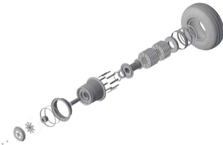
**Рисунок 2 – Тормозное колесо в разнесенном виде**
