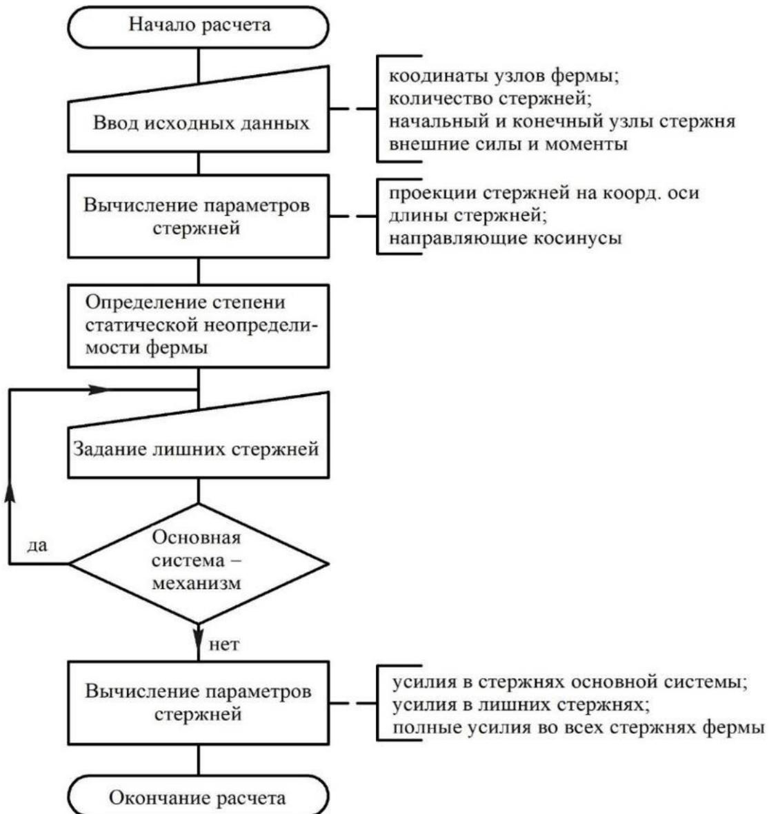
Рисунок 1 – Блок-схема расчета усилий в стержнях статически неопределимой фермы методом сил
