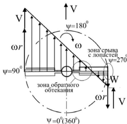
**Рисунок 4 – Зоны срыва с лопастей и обратного обтекания в азимуте  $\psi = 270^\circ$**
