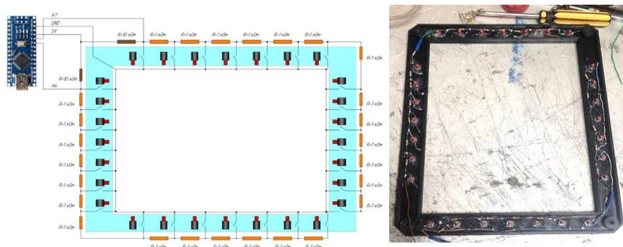
**Рисунок 3 – Принципиальная схема подключения кнопок к микроконтроллеру и фото с размещенной электрической цепью в корпусе МФЦИ**
