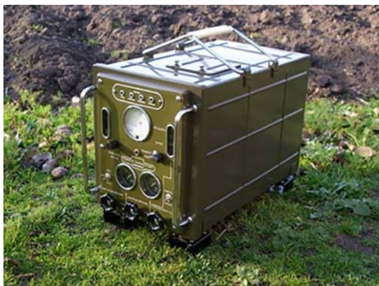
Рисунок 3 – Автоматический фотоэлектронный индикатор влажности 8Ш-31
