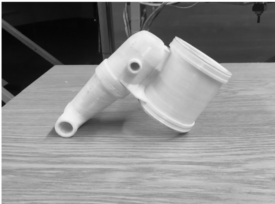
Рисунок 3 – Кронштейн стойки, напечатанный с помощью 3D-технологий
