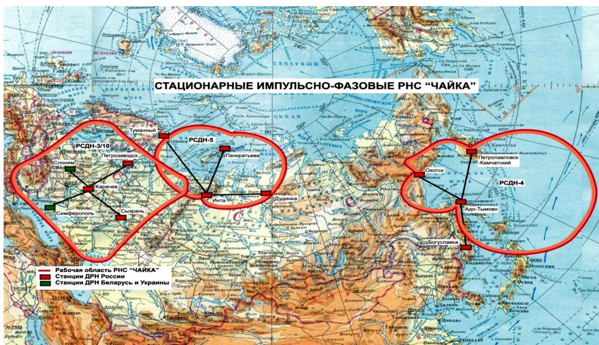
Рисунок 1 – Расположение наземных станций системы РСДН «Чайка» Преимуществами использования РСДН «Чайка» является [4]:
