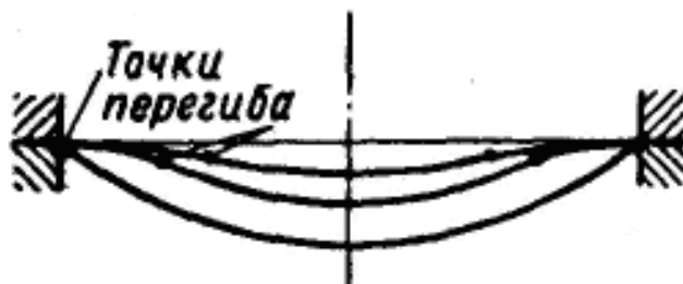
Рисунок 1 – Формы упругой поверхности мембраны, защемленной по контуру, на различных этапах нагружения: по мере роста разности давлений по обе стороны мембраны и увеличения деформации мембраны точки перегиба и зоны зарождения микротрещин смещаются от центра в направлении контура
