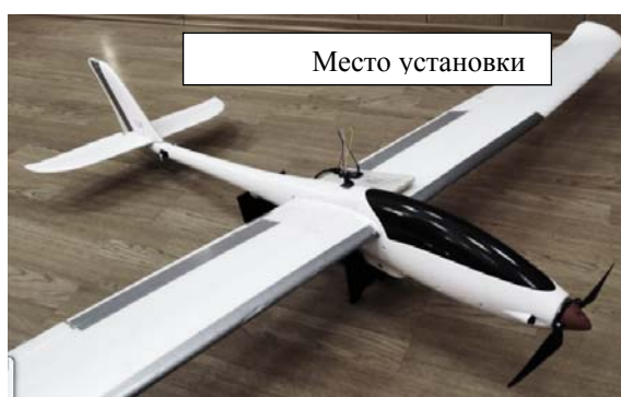
Рисунок 1 – Место установки датчика GY-91 на БЛА
