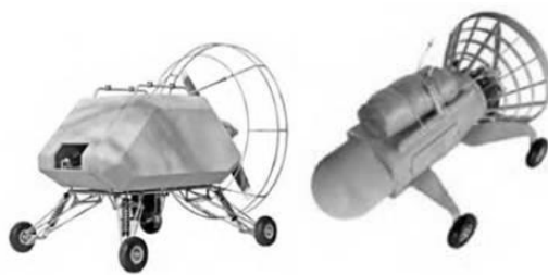
Рисунок 2 – Беспилотные мотопарапланы фирмы Atair Aerospace
