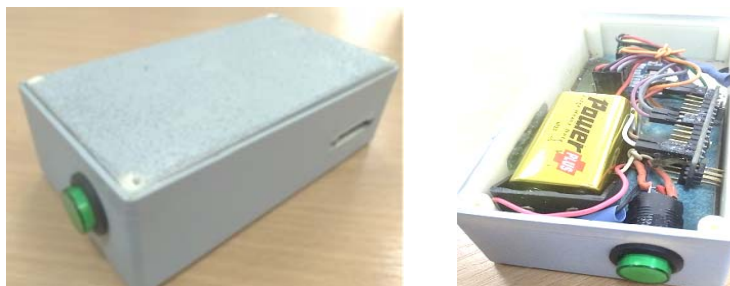
Рисунок 1 – Внешний вид полученной навигационной системы, собранной с использованием ARDUINO NANO, SD и GY-91
