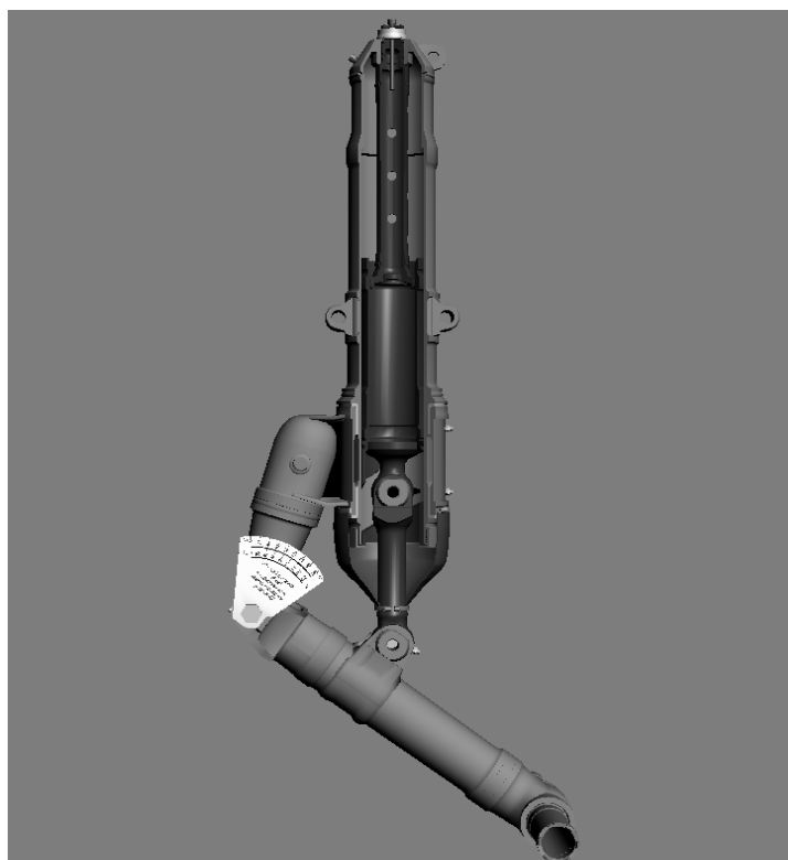
Рисунок 2 – Передняя опора вертолета Ми8-МТВ-5 в сборе с разрезом
