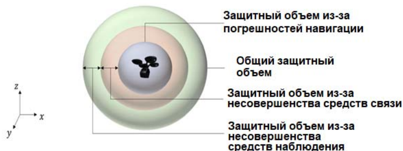
Рисунок 2 – Защитный объем БПЛА и его составляющие
