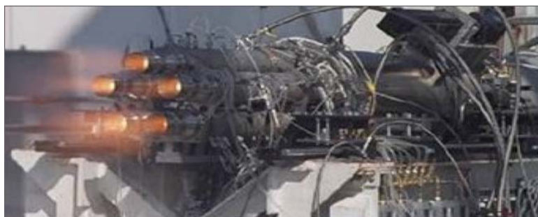
Рисунок 4 – Огневые испытания ТРД с детонационными камерами («Шок»)
