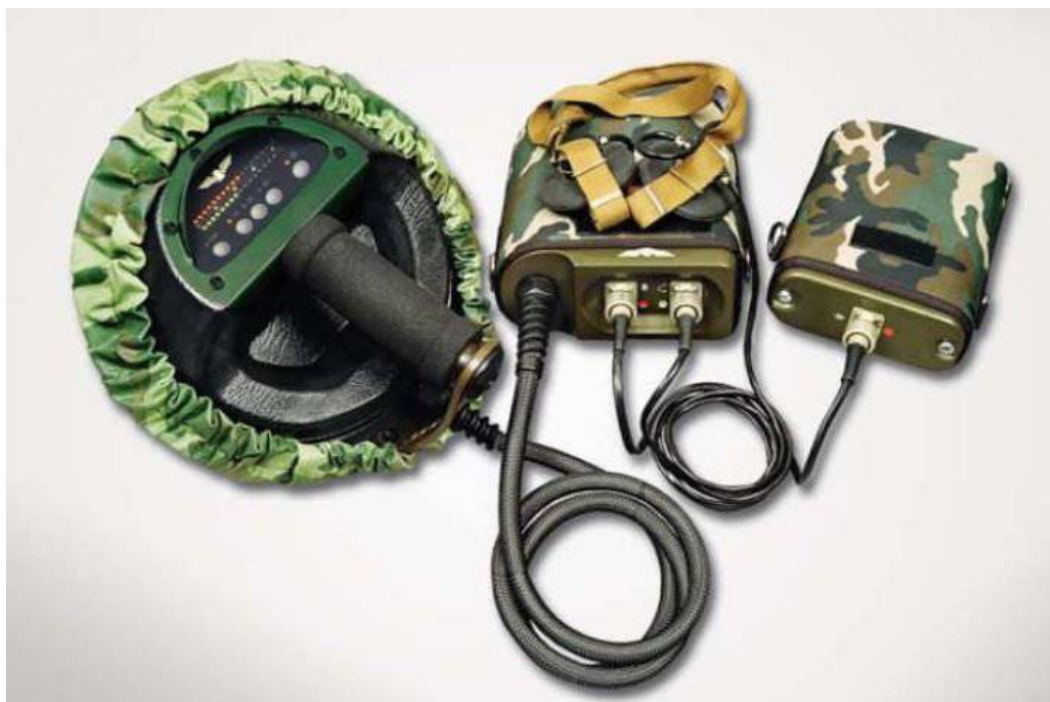
Рисунок 1 – Локатор нелинейного типа НР900ЕК «КОРШУН»
