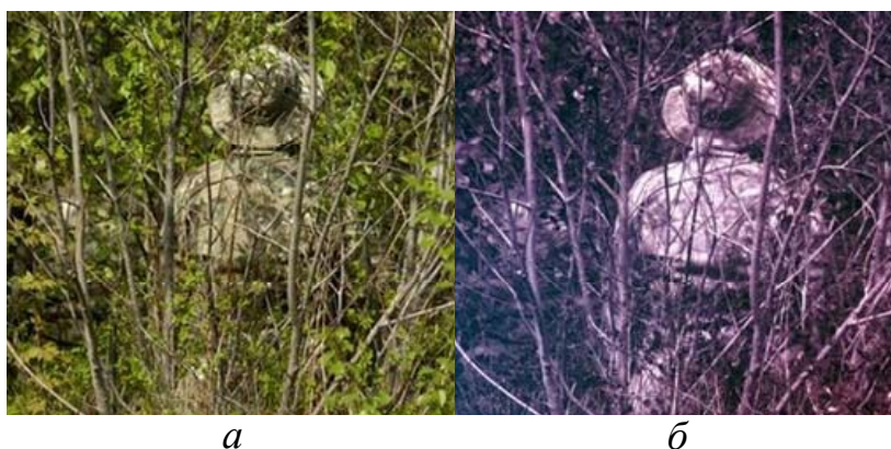
Рисунок 5 – Изображение защитной одежды военнослужащего: а – видимый диапазон; б – УФ диапазон
