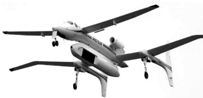
Рисунок 1 – Proteus (США, Scaled Composites). Есть вариант с пилотом и вариант беспилотный. Крылья располагаются тандемно
