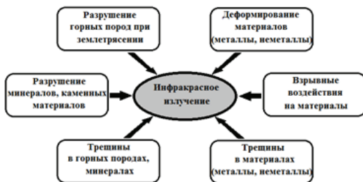
Рисунок 4 – Инфракрасное излучение при различных видах механических воздействий
