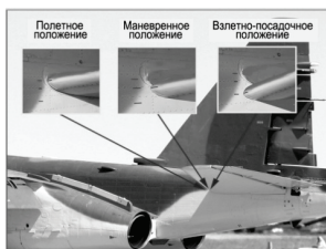
Рисунок 1 – Установка стабилизатора самолета Су-25
