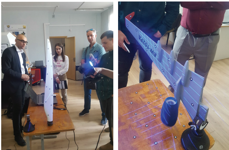
Рисунок 1 – 3D-сканирование ручным 3D-сканером Creaform HandySCAN BLACK предоставленный компанией IQB Technologies
