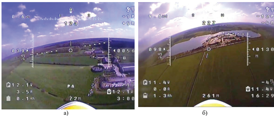
Рисунок 1 – Результаты регистрации изображений местности оптико-электронной системой при полете к первому ориентиру (а) и при полете ко второму ориентиру (б)
