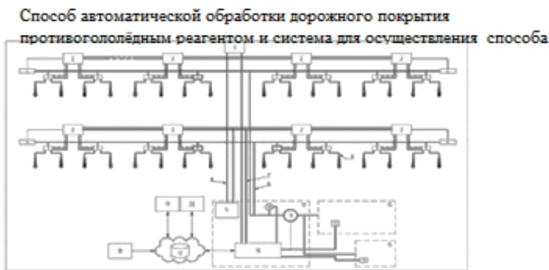
Рисунок 1 – Схема системы автоматической обработки дорожного покрытия противогололедным реагентом
