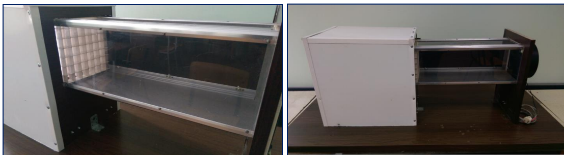
Рисунок 7 - Аэродинамическая труба дозвуковых скоростей
